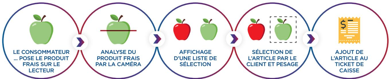
L'intégralité de ce processus peut être automatisée à l'aide de caméras 3D et d'algorithmes d'apprentissage. Il suffit de poser ses produits frais sur la balance équipée d'une caméra. La technologie de reconnaissance identifie l'article et suggère le nom. Une fois confirmé par le client, l'article est ajouté au ticket de caisse d'un simple clic. Cela simplifie le passage en caisse tout en réduisant les interventions du personnel nécessaires pour les produits frais mal étiquetés.
